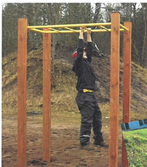
Riipuntateline itse valmistettuna, materiaalikustannukset 350€
